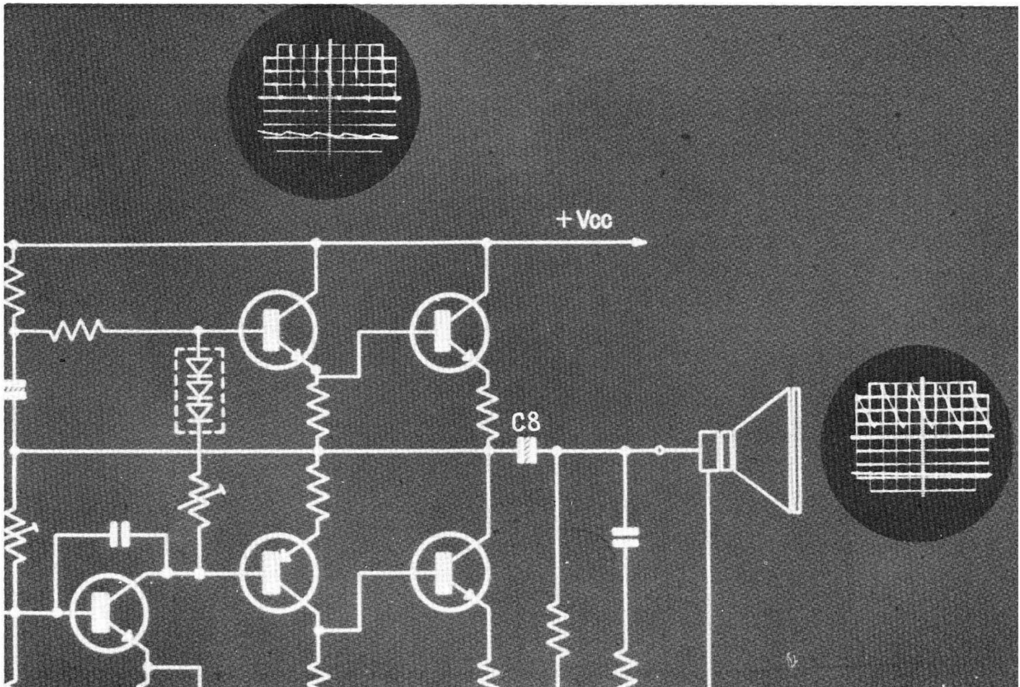
39. SINCE THE UPPER TRANSISTOR IS SHORTED IT OVERLOADS THE POWER SUPPLY AND CAUSES HUM IN THE SPEAKER. THE REASON YOU SUSPECT THE UPPER TRANSISTOR TR5 AND NOT TR4 IS BECAUSE TR5 HANDLES THE POSITIVE COMPONENT OF THE SIGNAL BEING AMPLIFIED. THE ONLY PLACE THE RIPPLE COMPONENT CAN GO IS THROUGH THE COUPLING CAPACITOR C-8 AND THE SPEAKER TO GROUND. THIS IS WHY WHEN YOU HEAR A BUZZING SOUND THROUGH THE SPEAKER YOU SUSPECT THE UPPER TRANSISTOR OF THE PAIR IS SHORTED.
