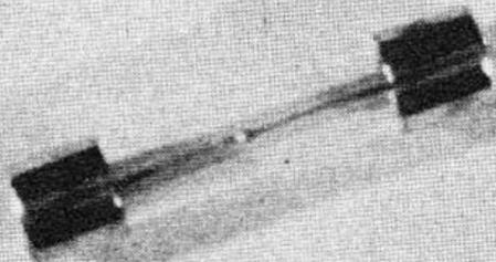
**THE FUSE BLOWS WHILE YOU HEAR A BUZZING SOUND THROUGH THE SPEAKERS**
