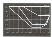
Diversi effetti di Riduzione del Disturbo Il grafico sopra riportato mette a confronto gli effetti di riduzione del disturbo dei tre sistemi Dolby NR. Il Dolby S riesce a raggiungere un miglioramento di 10 dB nella riduzione del disturbo alle basse frequenze (100 Hz) e ad ottenere notevoli miglioramenti sull'intero spettro udibile.
