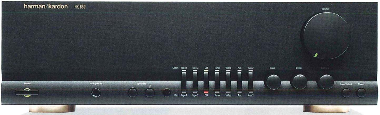
**HK680** Amplificatore integrato • Progetto Extra High Current con triplo stadio di uscita Darlington, dispositivi di uscita paralleli ad alta velocità e potenti stadi pilota
