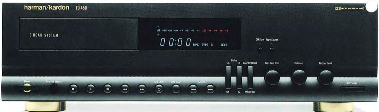
**TD450** Registratore a tre testine • Riduttori di rumore Dolby B/C e HX Pro • Meccanica orizzontale a tre motori • Stabilizzatore antivibrazioni per la cassetta • Testine Isotropic • Amplificatori di riproduzione a componenti
