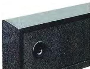
Gli angoli dei mobili dei modelli TLX 12, TLX 14, TLX 16, TLX 18 e TLX 20 sono stati tagliati a 30° per ridurre ulteriormente gli effetti di diffrazione e migliorare l'immagine stereo del suono.
