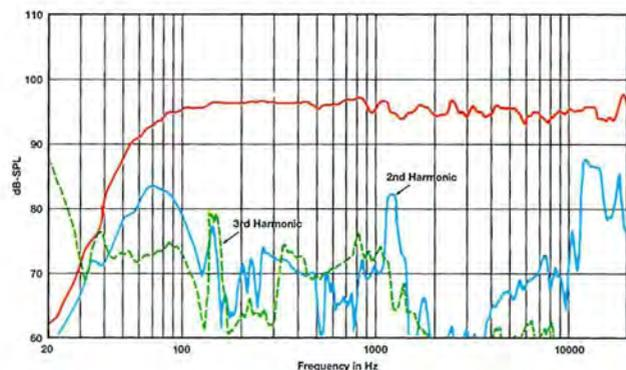
**4208:** Curva di distorsione in funzione della frequenza (96 dB a 1 metro) a livelli di ascolto tipici da studio (la distorsione è stata elevata di 20 dB).
