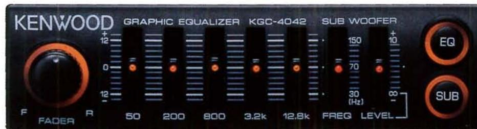
• 5 bande: 50, 200, 800, 3,2 k, 12,8 kHz • Livello di equalizzazione:  $\pm 18$  dB a 50 Hz e 200 Hz,  $\pm 12$  dB a 800 Hz-3,2 k-12,8 kHz • Uscita (mono) subwoofer con controllo guadagno ( $-\infty$  a 10 dB) • Taglio frequenze subwoofer (30 Hz a 150 Hz) • Pendenza di taglio subwoofer 12 dB/oct • Funzione elimina basso: le uscite front e rear inferiori a 100 Hz vengono tagliate per mi-
