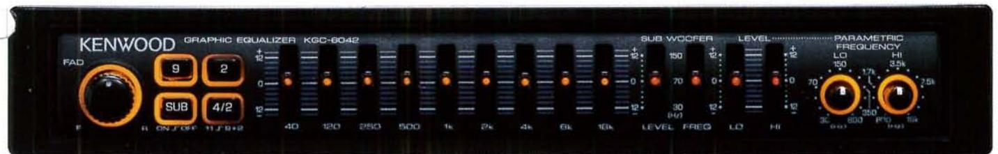
• Bande totali 11 • 9 bande: equalizzatore grafico (40, 120, 250, 500, 1-k, 2 k, 4 k, 8 k, 16 kHz); 2 bande: equalizzatore parametrico con frequenza variabile in modo continuo (30 Hz - 800 Hz, 800 Hz - 16 kHz) • Comandi di frequenza parametrica (Low-Hi) rotativi • Livelli di calibrazione parametrica (Low-Hi)  $\pm 12$  dB • 9 bande rear • 2 bande parametriche front • Taglio frequenze sub-
