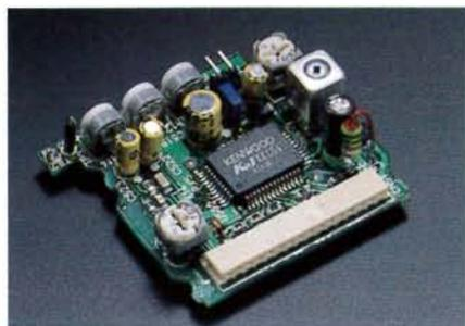
Sintonizzatore **K<sub>2</sub>I** a chip ibrido ultra stabile per l'analisi delle onde sonore, soppressione del rumore e circuiti di demodulazione multiplex.
