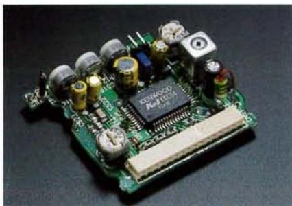
Sintonizzatore **K2I** a chip ibrido ultra stabile per l'analisi delle onde sonore, soppressione del rumore e circuiti di demodulazione multiplex.
