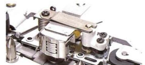
Il sistema Dual Azimuth mantiene il corretto angolo di azimuth in entrambe le direzioni
