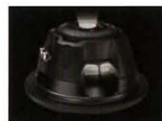
L'efficace dissipazione del calore e la riproduzione dei bassi è stata ottenuta ricavando una porta nel lato del telaio e della calamita, e una al centro della superficie posteriore. La riduzione delle dimensioni è stata resa possibile inserendo le aperture sulle superfici laterali e posteriori, con una conseguente custodia più sottile del woofer.
