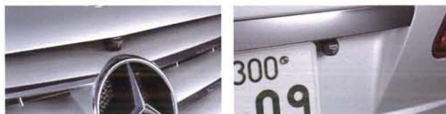
La videocamera CMOS-310 multi-angolare è munita di un processore avanzato delle immagini in grado di alterare le angolazioni di visualizzazione, aumentare il numero di schermi, aggiungere istruzioni grafiche all'immagine della videocamera. È possibile passare comodamente dall'una all'altra opzione dal touch screen o da un interruttore collegato.
