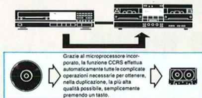
Grazie al microprocessore incorporato, la funzione CCRS effettua automaticamente tutte le complicate operazioni necessarie per ottenere, nella duplicazione, la più alta qualità possibile, semplicemente premendo un tasto.
