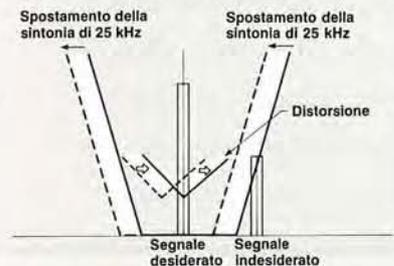
zandola di 25 kHz ed eliminando la distorsione risultante. Allo scopo di facilitare il funzionamento, è stato incluso un controllo di ricezione attiva, che seleziona automaticamente la migliore posizione del selettore RF e IF di ciascun segnale in arrivo. È possibile ridurre il numero delle informazioni del display, in modo che indichi soltanto l'intensità del segnale in ingresso e le condizioni dei canali adiacenti, oppure solo la frequenza sintonizzata.
