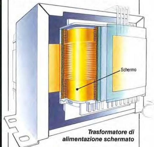
la linea di massa. Isolando la linea di massa mediante un amplificatore separatore che assorbe le interferenze di rumore esterno prima dell'alimentazione e schermando gli avvolgimenti primari e secondari del trasformatore di alimentazione, si è riusciti a proteggere i dispositivi più delicati, come il convertitore D/A e il filtro analogico. Il sistema a Linea di Massa Isolata fa in modo che il loro collegamento a terra sia assoluta-
