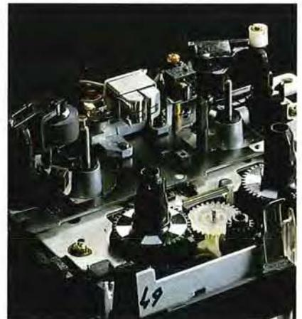
impedisce alle vibrazioni di disturbare lo scorrimento del nastro, pregiudicando il segnale. I capstan si muovono a velocità diverse, per evitare il rumore di intermodulazione; la tensione del nastro risulta migliore, rendendone lo scorrimento più uniforme.
