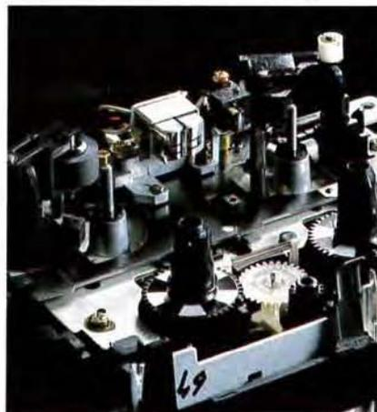
impedisce alle vibrazioni di disturbare lo scorrimento del nastro, pregiudicando il segnale. I capstan si muovono a velocità diverse, per evitare il rumore di intermodulazione; la tensione del nastro risulta migliore, rendendone lo scorrimento più uniforme.
