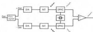
a riallineare il segnale d'uscita analogico contenente "jitter" con il "master clock", che ne è esente. Il risultato è una riproduzione accurata, fedele e assolutamente naturale.
