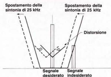
zandola di 25 kHz ed eliminando la distorsione risultante. Allo scopo di facilitare il funzionamento, è stato incluso un controllo di ricezione attiva, che seleziona automaticamente la migliore posizione del selettore RF e IF di ciascun segnale in arrivo. È possibile ridurre il numero delle informazioni del display, in modo che indichi soltanto l'intensità del segnale in ingresso e le condizioni dei canali adiacenti, oppure solo la frequenza sintonizzata.
