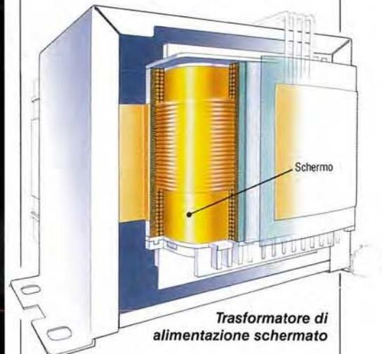
la linea di massa. Isolando la linea di massa mediante un amplificatore separatore che assorbe le interferenze di rumore esterno prima dell'alimentazione e, schermando gli avvolgimenti primari e secondari del trasformatore di alimentazione, si è riusciti a proteggere i dispositivi più delicati, come il convertitore D/A e il filtro analogico. Il sistema a Linea di Massa Isolata fa in modo che il loro collegamento a terra sia assoluta-
