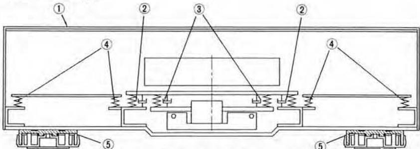
① Contenitore a doppio strato ② Isolatore della meccanica: gomma ③ Isolatore ibrido: gomma e molle a spirale ④ Isolatore della piastra circuitale ⑤ Piedino isolatore in resina termoplastica all'elastomero di poliestere
