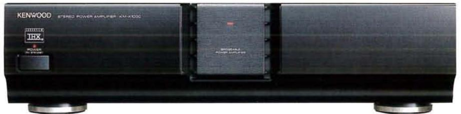
■ Finale di potenza certificato THX ■ Ideale completamento del KR-X1000 per il pilotaggio dei subwoofer THX ■ Potenza massima stereo: 190W + 190W (DIN, 6 ohm) ■ Potenza dinamica: 240W (mono, 4 ohm) ■ Stadio finale a componenti discreti ■ Circuito esclusivo Kenwood "Pure Inverted Drive" per alta linearità ed efficienza ■ Doppio trasformatore duale ■ Connettori per ogni tipo di cavo audio
