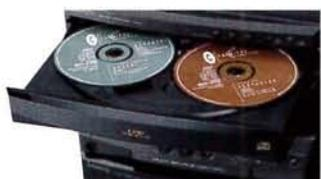
Multiletto di tipo rotante da 3 dischi
