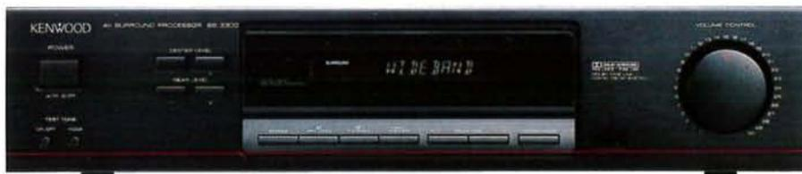
■ Abbinato ad un amplificatore stereo consente l'uso in Dolby Surround su 5 canali ■ Potenza d'uscita 37W per canale centrale e 15W + 15W per canali surround (DIN, 8 ohm) ■ Decoder Dolby Pro Logic, 3CH e modalità normal/wide/phantom ■ Bilanciamento automatico degli ingressi e tono di prova per il video ■ Ritardo digitale ■ Controllo volume per canali centrale/posteriori
