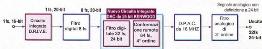
Schema a blocchi del sistema Fine D.R.I.V.E. a 24-bit
