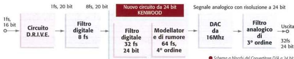
● Schema a blocchi del Convertitore D/A a 24 bit
