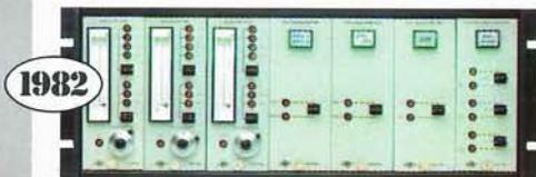
**5558 Sistema per banchi prova.** Installazione permanente a 3 canali per le misure di vibrazione su banchi prova turbine di reattori aviazione.
