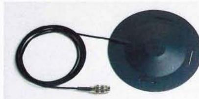
**4322 Accelerometro triassiale per sedile.** Viene usato insieme al 2512 per misure in tre direzioni mutuamente perpendicolari.
