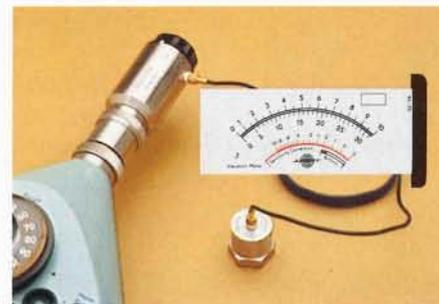
Il Tipo 2209 usato come misuratore di vibrazioni con l'integratore ZR 0020
