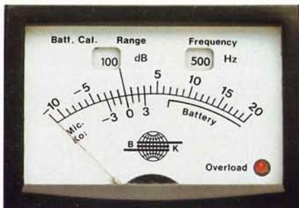
Scala di misura del 2215 con indicazione di filtri e attenuazione selezionati
