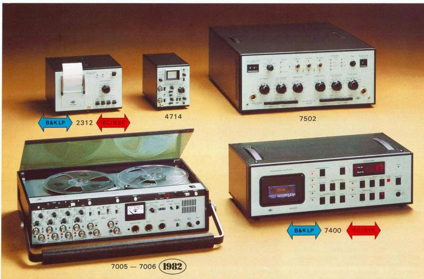
**4714 Oscilloscopio.** Piccolo oscilloscopio portatile costruito dalla National-Matsushita Company. Ideale per sorveglianza di segnali di vibrazione e ricerca guasti e riparazione di sistemi analogici e digitali.
