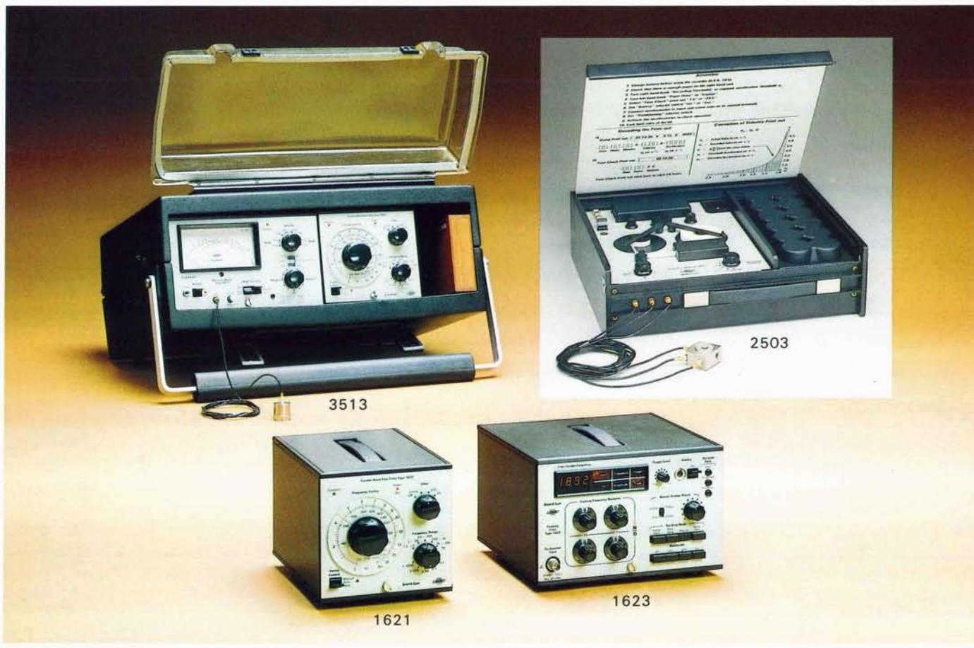
**1621 Filtro passabanda sintonizzabile.** Filtro portatile per analisi in frequenza a banda percentuale costante per l'uso con il misuratore di vibrazioni 2511 e i fonometri 2203, 2209, 2210 e 2218.
