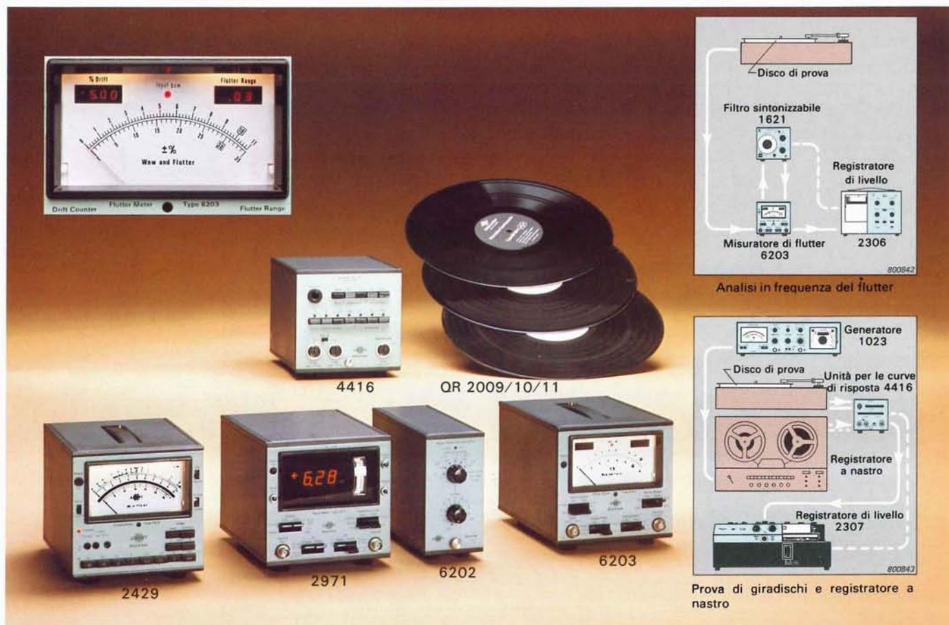
**2429 Psofometro** per misure di rumore a frequenza audio su telefoni e sistemi di comunicazione. Conforme alle CCITT P53 e CCIR 468-1.
