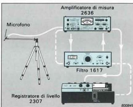
Analisi in frequenza con controllo automatico del tempo di media
