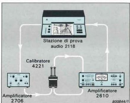
Misure di distorsione armonica e di intermodulazione su microfoni ad alti livelli di pressione
