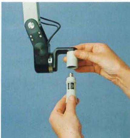
Facile intercambiabilità dei trasduttori con sistema ad innesto e blocco automatico
