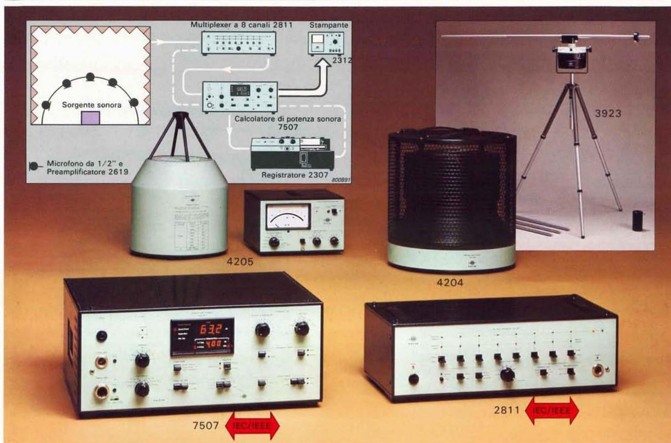
**7507 Calcolatore di potenza sonora.** Analizzatore parallelo a ottave e terzi d'ottava e calcolatore per la valutazione della rumorosità di macchine, veicoli, elettrodomestici ecc. e per la determinazione della loro potenza sonora in ambienti comuni o in camere anecoiche o riverberanti. Conforme alle norme ISO da 3741 a 3745 e DIN 45635.
