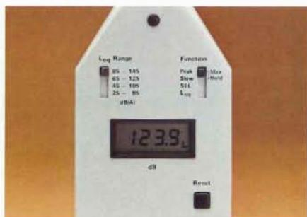
Fonometro integratore di precisione tipo 2222. Il tipo 2221 ha la costante di tempo "Fast" invece della "Slow"
