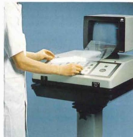
Montaggio del foglio sterile sull'ecografo tipo 1849 per l'utilizzo in chirurgia
