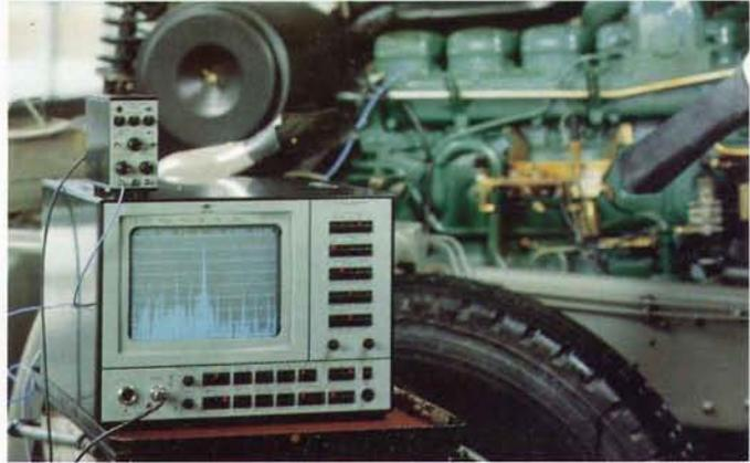
Analisi sul posto delle vibrazioni di un motore diesel
