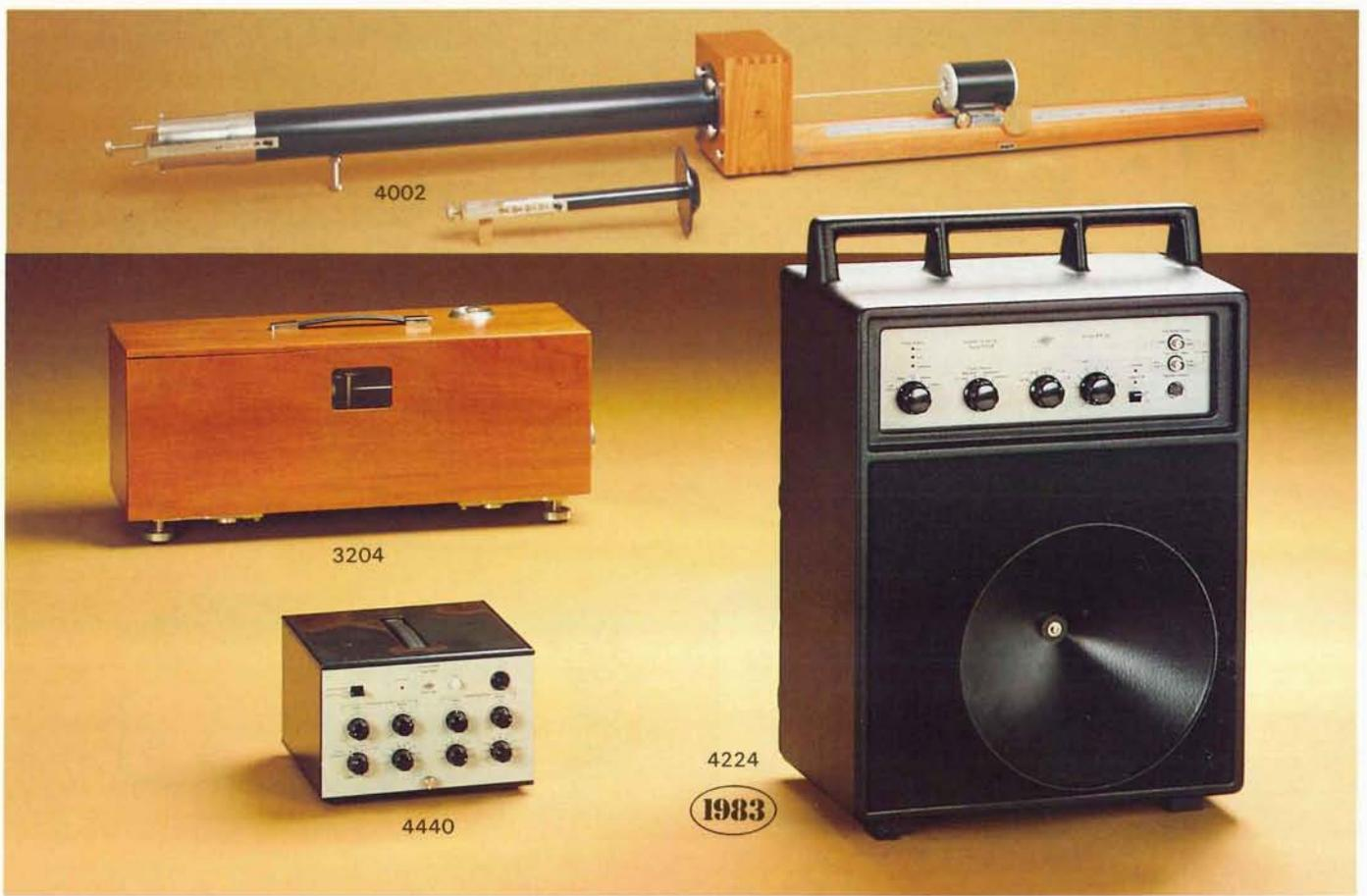
**4224 Sorgente sonora.** Funzionante a batterie e utilizzabile per la misura di tempi di riverberazione, assorbimento e isolamento.
