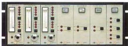
**5558 Sistema per banchi prova.** Installazione permanente a 3 canali per le misure di vibrazione su banchi prova turbine di reattori aviazione.
