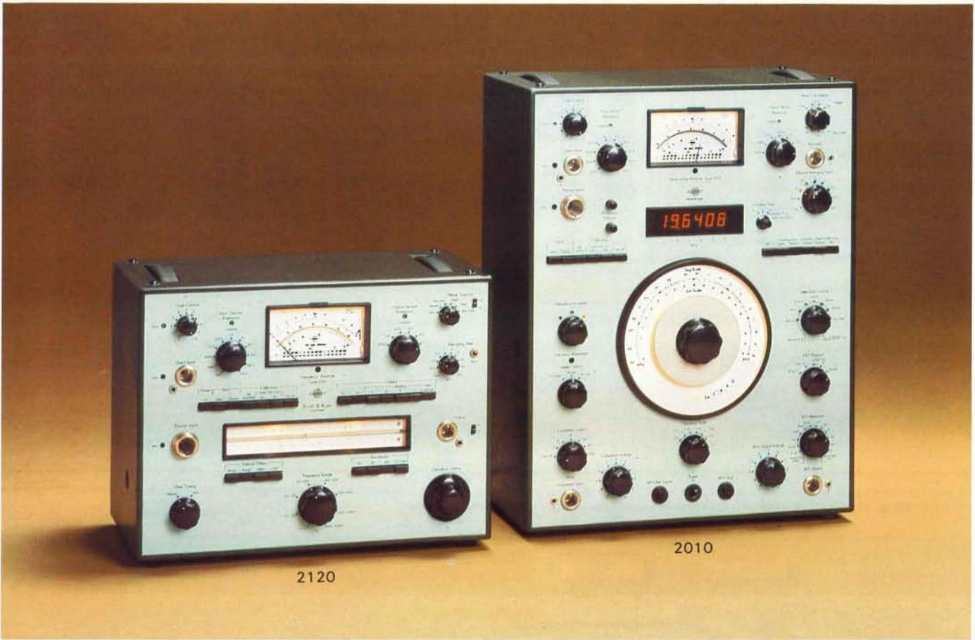
L'analisi in frequenza può essere realizzata in modo seriale, muovendo continuamente o a passi un filtro passa-banda lungo la banda di frequenza in esame. Gli analizzatori in frequenza sopra rappresentati sono particolarmente adatti a questo scopo. Essi comprendono un amplificatore di misura e un filtro passa-banda e possono essere sintonizzati a distanza, tramite un registratore di livello o X-Y, per la registrazione automatica dell'analisi.
