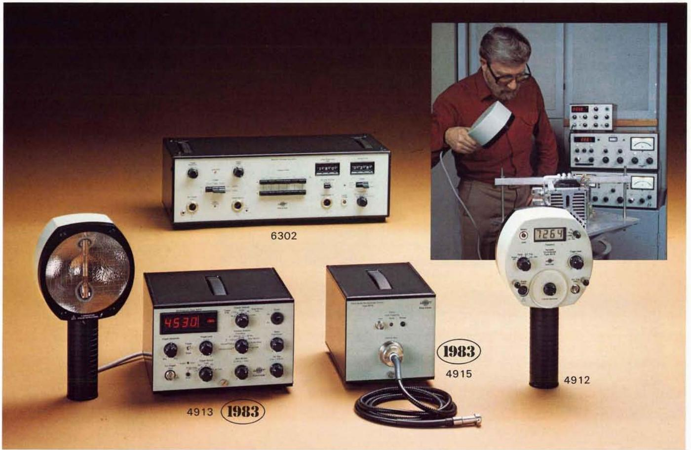
**6302 Analizzatore di forma d'onda.** Strumento portatile per determinare la forma d'onda delle vibrazioni di macchine rotanti a fini manutentivi o di sviluppo e ricerca guasti.
