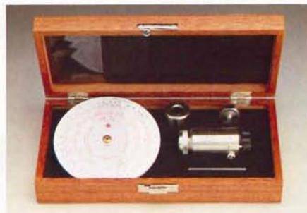
Integratore ZR 0020 per misure di vibrazione
