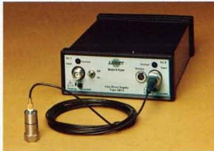
Amplificatore con alimentazione in linea tipo 2644 montato sull'accelerometro tipo 4384 e alimentatore in linea tipo 2813
