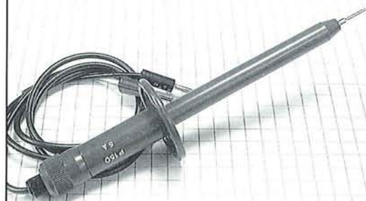
P-150 Puntale per la misurazione di alte tensioni da impiegare con multimetro analogico R 131. Massima tensione applicabile: 30 kV. Fattore di riduzione: 100 con utilizzatore a 10 MΩ. Impedenza d'ingresso: 1000 MΩ.
