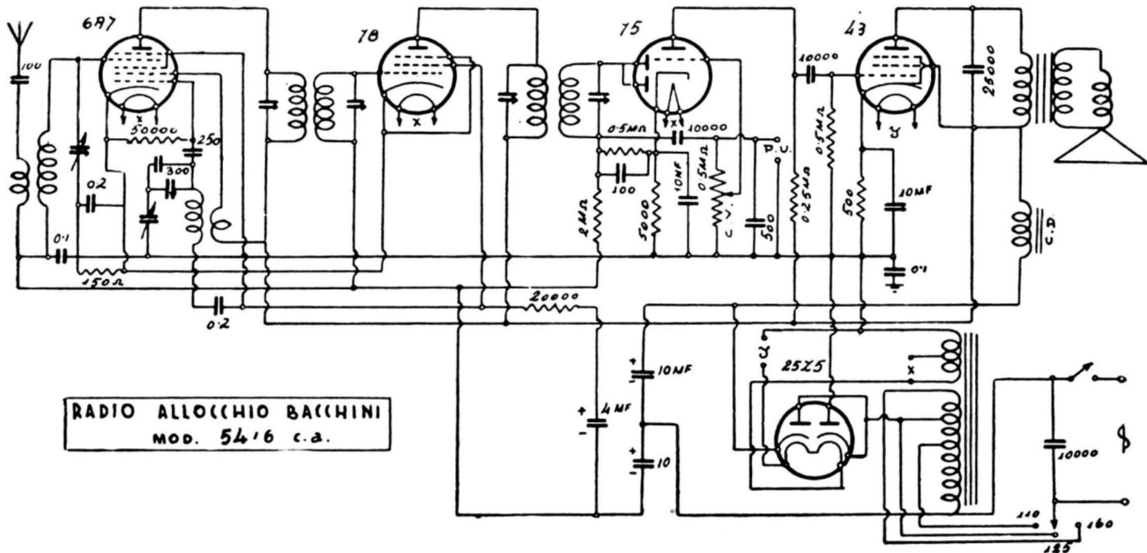
Onde medie. - Trasform. m. f. 175 kc. - Alimentazione con raddrizzatrice-raddoppiatrice 25 Z 5. - Controllo automatico di volume. - Accoppiamento elettronico. - Potenza uscita 2 watt.
