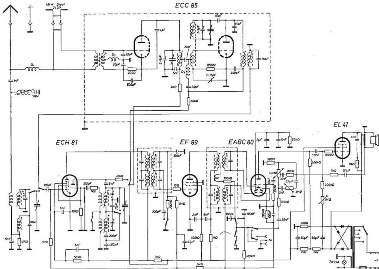
CONTINENTAL (Continental-Rundfunk GmbH, Osterode, Harz) - Mod. Imperial 250 - Ricevitore a modulazione di ampiezza e di frequenza. Onde lunghe da 140 a 375 kc/s, onde medie da 510 a 1700 kc/s, onde ultracorte FM da 87,5 a 100,5 Mc/s. Commutazione di gamma e di accensione con quattro tasti. Altoparlante ellittico. Resa di uscita 2 watt. Prod. 1956.
