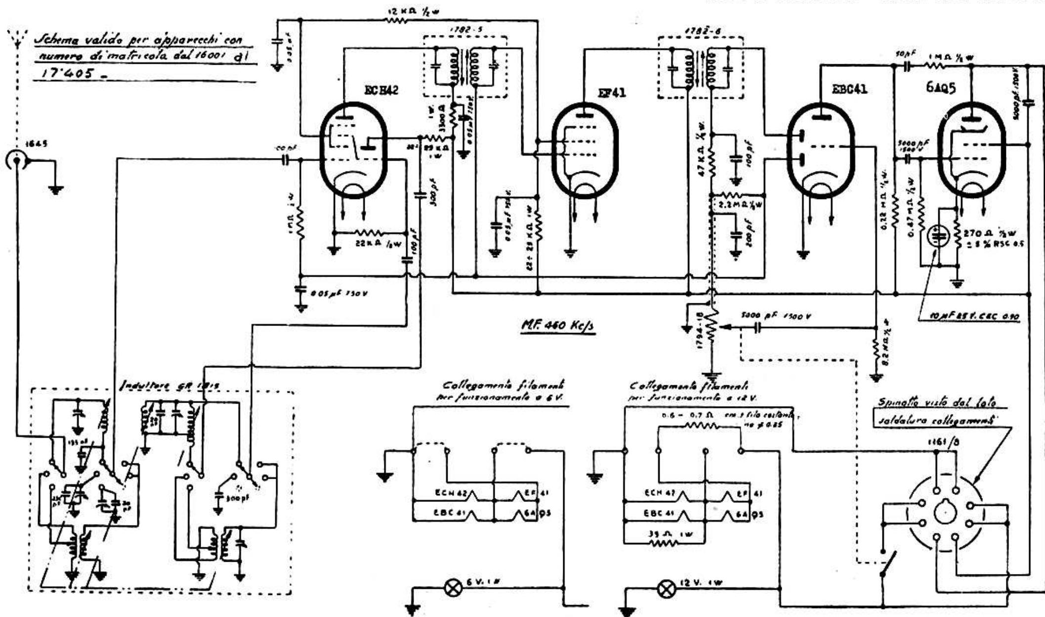
GALLO-CONDOR - Mod. ULTRA-PLAT seconda serie - Apparecchio radio da automobile. Sintonia a permeabilità variabile. Onde medie, corte e cortissime. Media frequenza a 46 kc. Resa d'uscita 3 watt.
