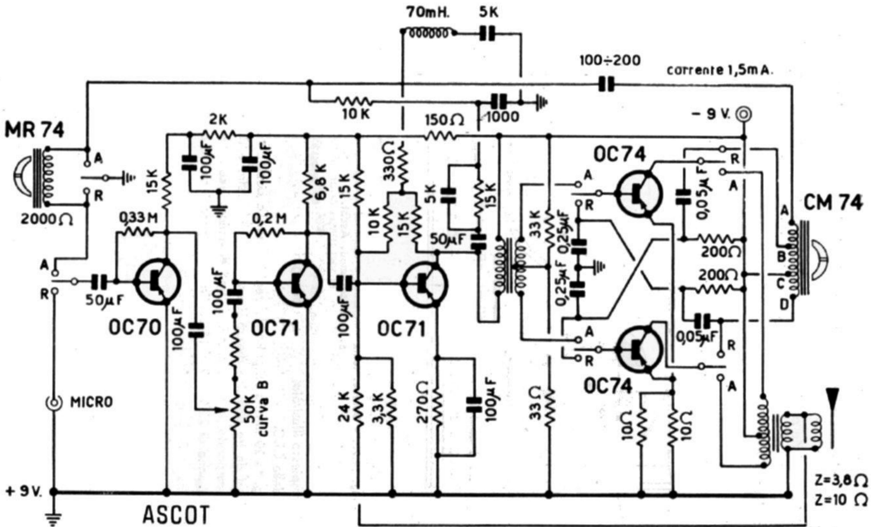
Fig. 14.19 - Complesso elettronico a transistor del registratore magnetico portatile mod. Ascot della GBC.
