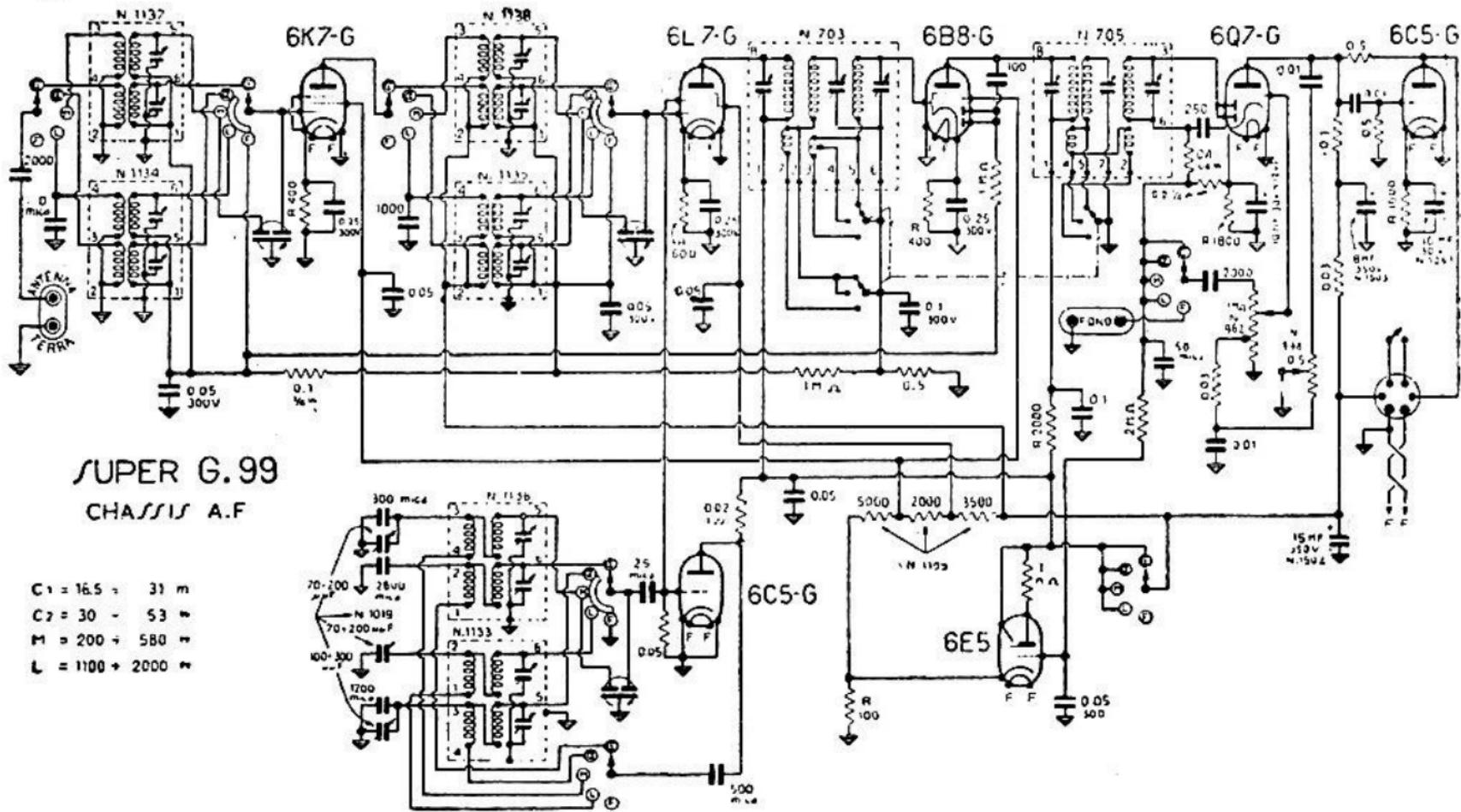
S. A. GELOSO. — Mod. G. 99. — Produzione 1939-1940. — Media frequenza: 467 kHz. — Potenza d'uscita: 25 watt.
