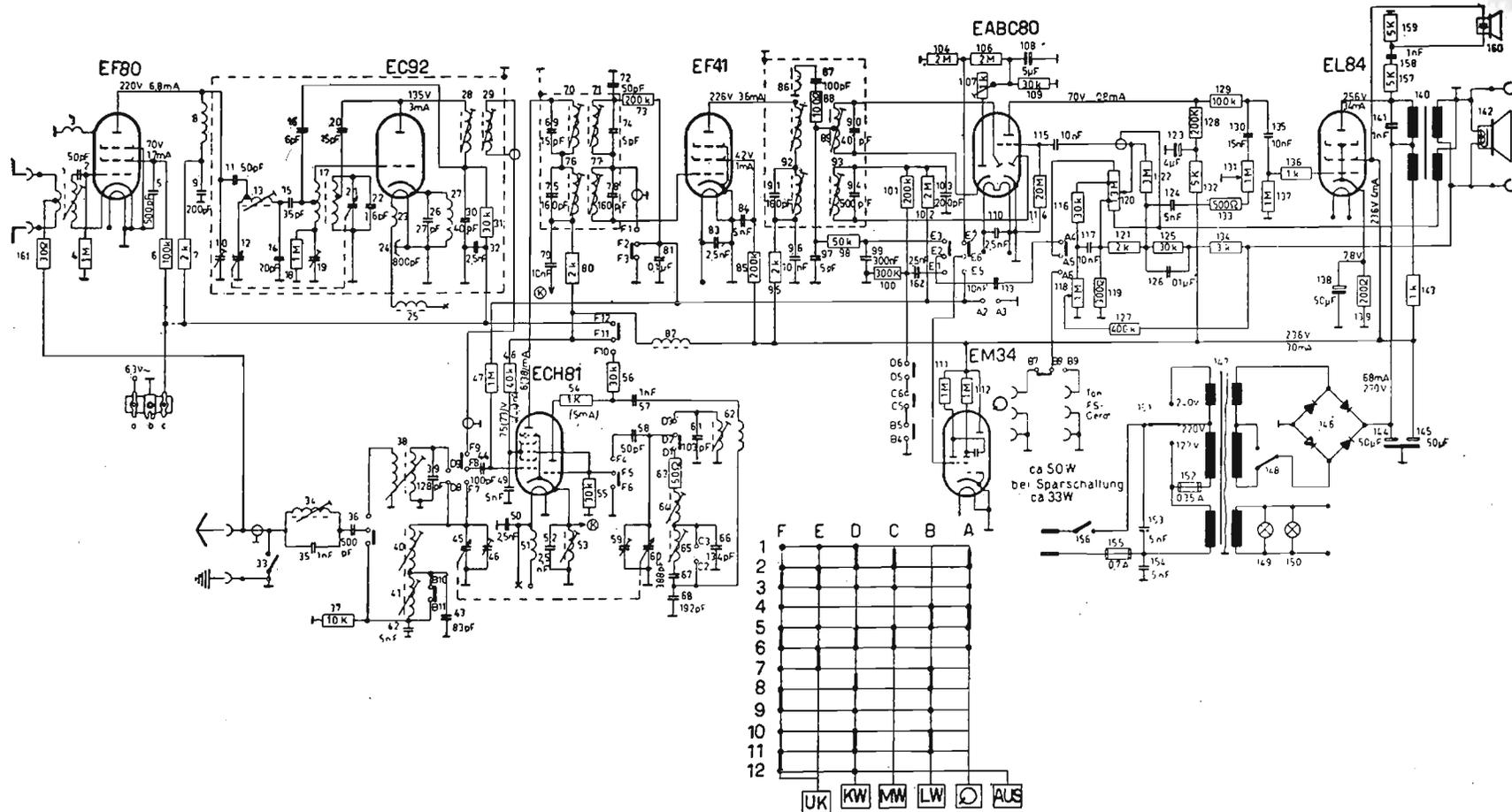
GRAETZ-SICART (Graetz Radio und Fernsehwerke, Altena) - Mod. Super 171 W. Apparecchio AM/FM, con tre gamme d'onda a modulazione d'ampiezza (lunghe, medie e corte) e una a modulazione di frequenza (onde ultracorte). Punti di allineamento: per OL 200 kc/s, per OM 600 e 1440 kc/s, per OC 7 Mc/s, per FM 88,5, 93 e 98 Mc/s. Ampia gamma sonora con due altoparlanti, di cui uno elettrostatico. Controlli dei toni bassi e alti. Potenza d'uscita indistorta 4 watt. (Produzione 1955).
