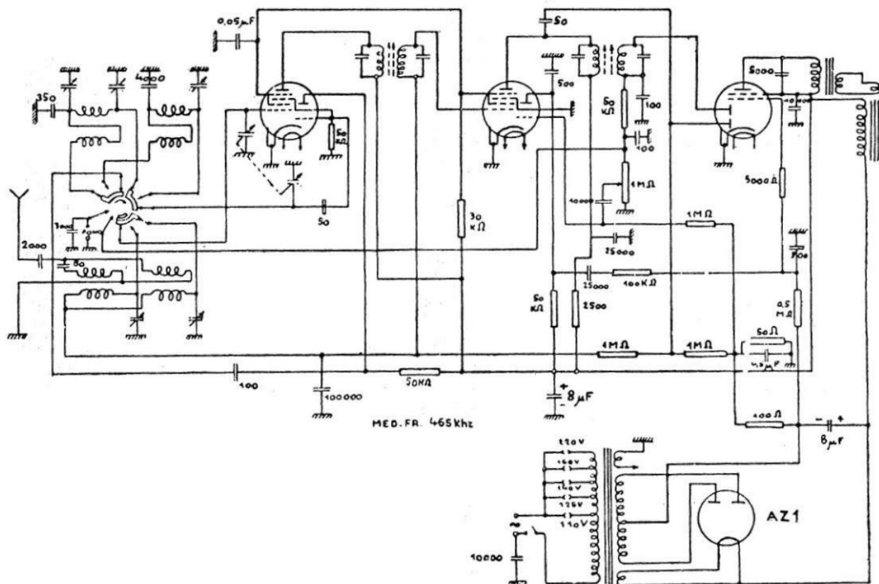
INCAR RADIO - Mod. LV 46 e LV 47 - La prima ECH4 provvede alla conversione di frequenza; la seconda ECH4 provvede all'amplificazione a MF e a BF. Media frequenza: 465 ke/s. Produzione 1945-46. (Il mod. LV 46 ha in più l'indicatrice di sintonia EM4).
