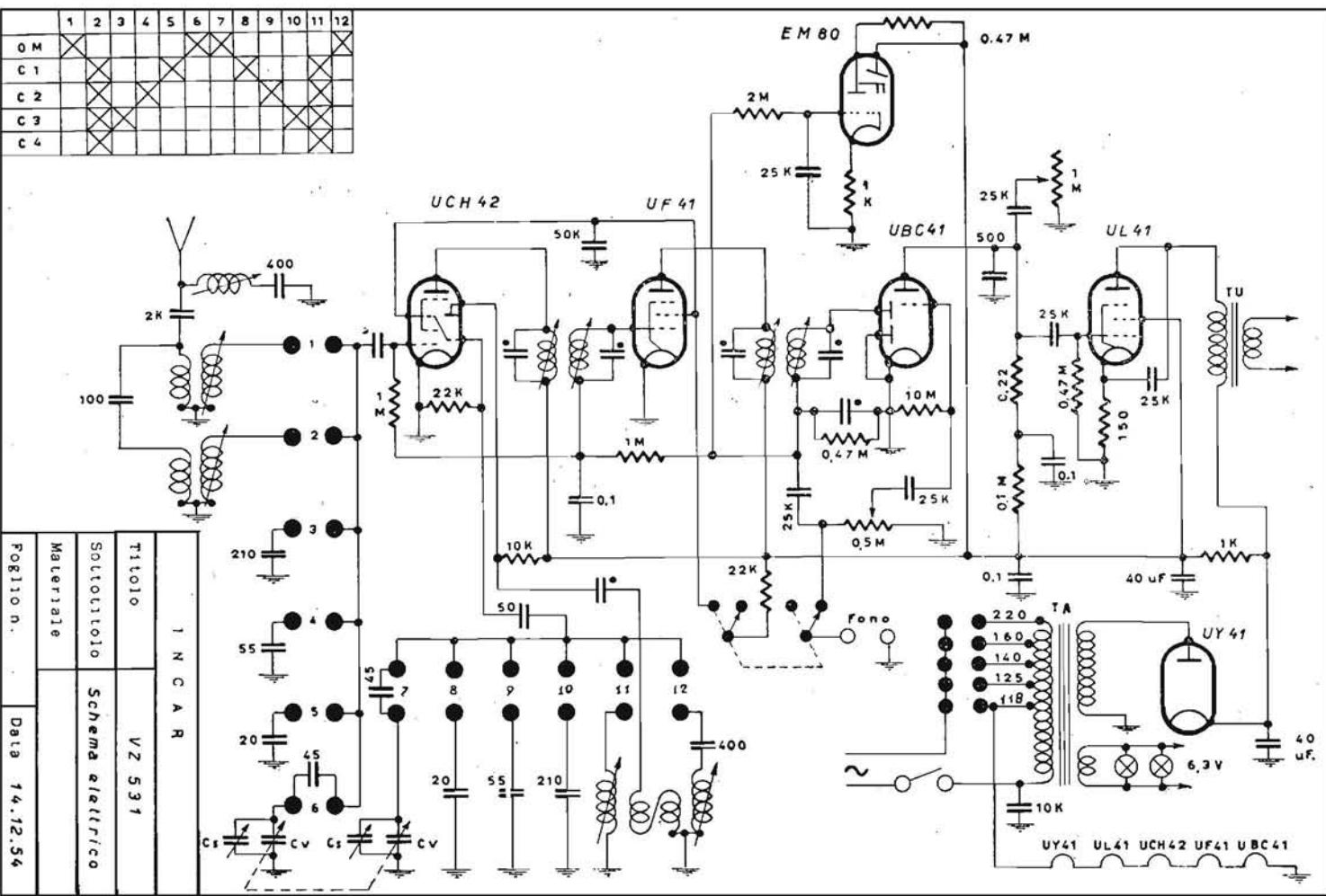
INCAR - Mod. VZ 531 - Ricevitore a onde medie con quattro bande allargate e quattro bande strette. Potenza d'uscita 3 watt. Cons. 50 watt.
