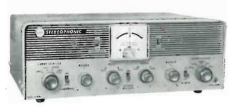
10-30.000 cps.  $\pm$  1 dB - 18 + 18 watt (12 + 12 indistorti) su 4, 8, 16 ohm - Sensibilità 2 mV FONO, 2 mV TESTINA NASTRO, 150 mV RADIO e AUSIL. - Comando Bassi e Acuti ( $\pm$  15 dB) indipendenti sui due canali - Compensazione fisiologica - Presa Cuffia - Filtro antirombo - Strumento di controlo della potenza emessa e del bilanciamento - Ronzio —90 dB 20 funzioni di valvola - Dimensioni mm 390  $\times$  135  $\times$  300.
