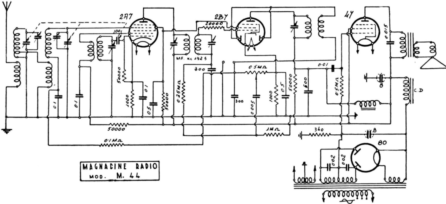
Onde medie. - M. F. 206 kc. - C. A. V. - Scala parlante. - Circuito reflex per c. a. v. - I due diodi della 2B7 sono adoperati solo per il c. a. v. - 47 con polarizzazione fissa di griglia. - Consumo totale di corrente anomica: 45 mA. - Potenza d'uscita: 2,5 watt.
