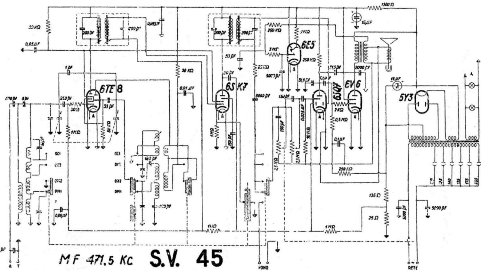
MAGNADYNE RADIO - Mod. SV 45 - Gamma onde medie divisa e due gamme onde corte. Sensibilità media OM 25 microvolt, OC 30 microvolt. Doppia reazione negativa. Potenza d'uscita 4 W. Altoparlante a magnete permanente.
