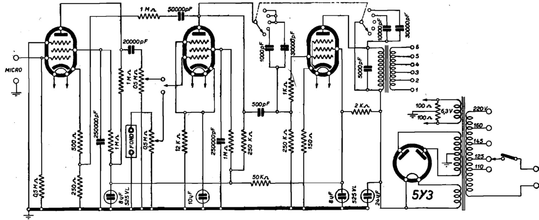
NOVA - Mod. 31. Potenza da 8 a 10 watt. Impedenze d'uscita: 2,5-5-10-15 ohm con cambia-impedenze, 20 ohm con collegamento int. 7.
