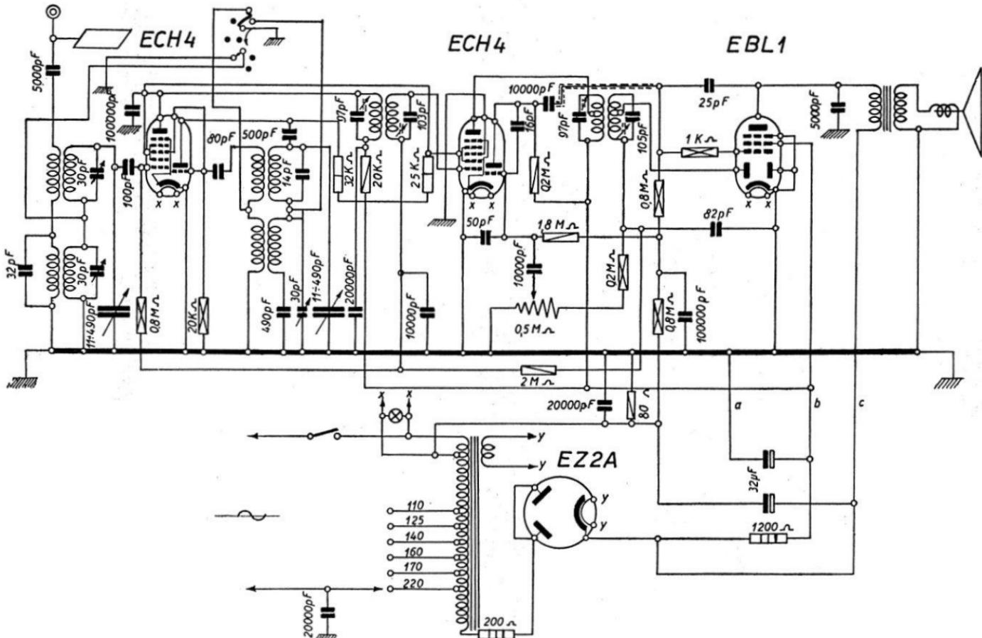
PHILIPS RADIO - Mod. BI 390 A e mod. BI 390 A bis - Onde corte e medie - Media frequenza 468 kc/s. Potenza d'uscita 2 W circa.
