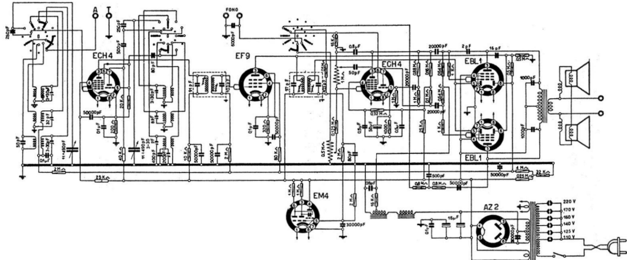
PHILIPS - Mod. DI 670 A - Radiofonobar con due valvole finali in controfase. Media frequenza: 468 kc/s. Produzione 1946-47.
