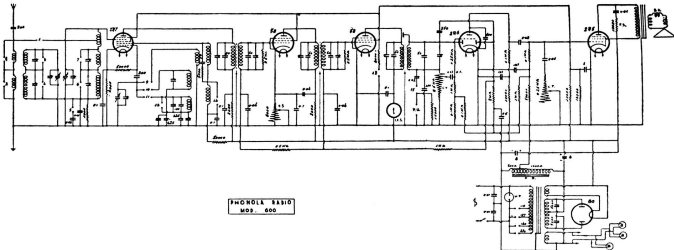
Onde medie e corte. - M. F. 175 kc. - C. A. V. - Variatore tono. - Scala parlante. - 2A7 oscill.-modul.;
