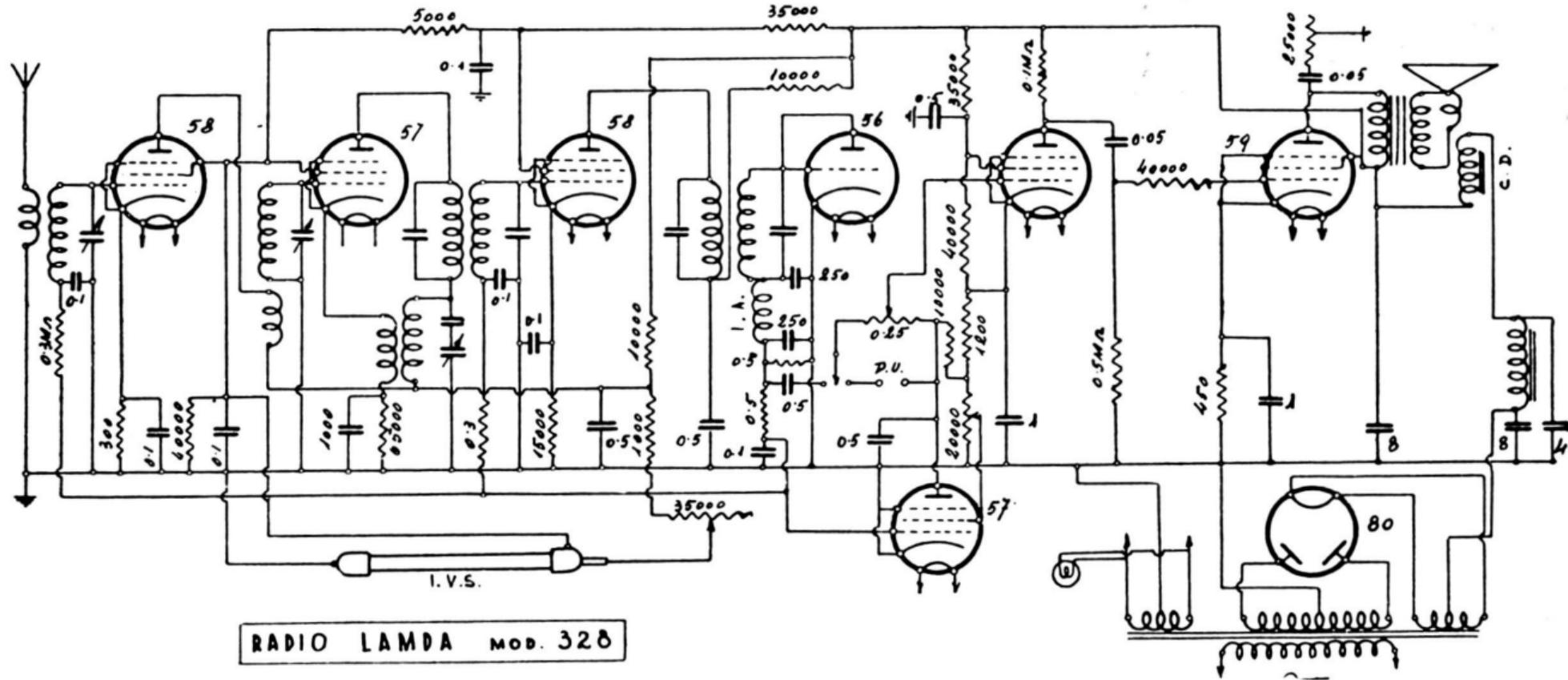
Onde medie. - M. F. 175 kc. - C. A. V. - C. T. - Indicatore ottico di sintonia. - 57 silenziatrice automatica. - 58 amplif. a. f.; 57 modul.-oscill.; 58 amplif. m. f.; 56 demodul.-c.a.v.; 57 amplif. di tensione; 59 finale di potenza. - Potenza d'uscita: 4 watt.
