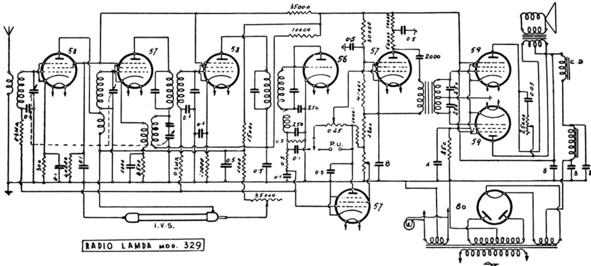
· Onde medie. - M. F. 175 kc. - C. A. V. - C. T. - Indicatore ottico di sintonia. - Silenziatrice automatica. - Controfase di 59 preceduto da una 57 amplificatrice di tensione. - Potenza d'uscita: 9 watt.
