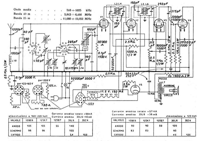
MARELLI - Mod. 114 - Media frequenza 455 kc. Bobina mobile 3,25 ohm. Consumo 40 watt. Potenza d'uscita 2,5 watt. Servizio come 11A25.
