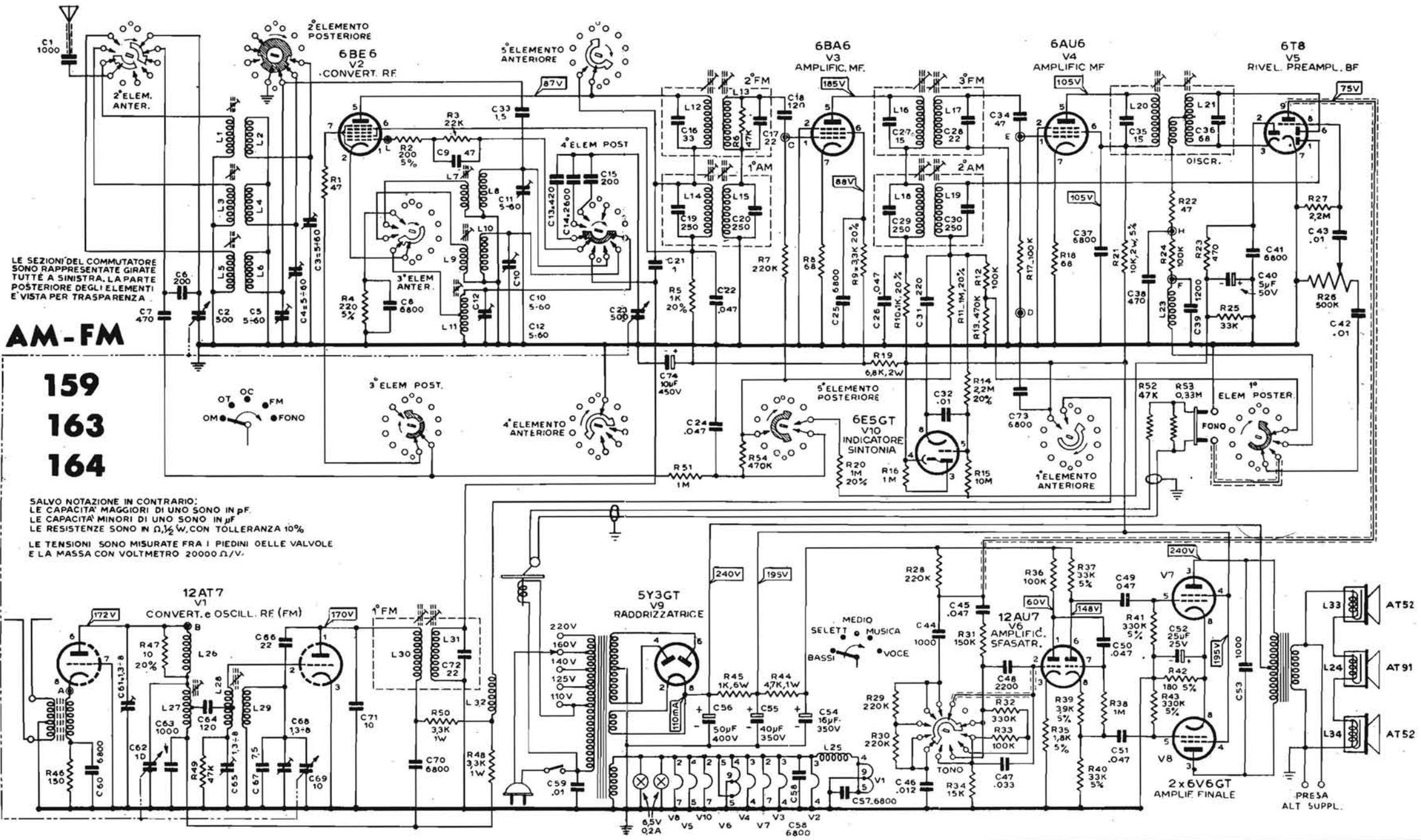
RADIO MARELLI - Modd. AM/FM 159, 163 e 164. I valori, i limiti di gamma e le istruzioni di taratura sono riportate a parte. Lo schema è del mod. 164; il mod. 163 è senza fonorivelatore; il mod. 159 è con fonorivelatore ma a un solo altoparlante. Potenza d'uscita 6,5 W. Consumo 78 W.
