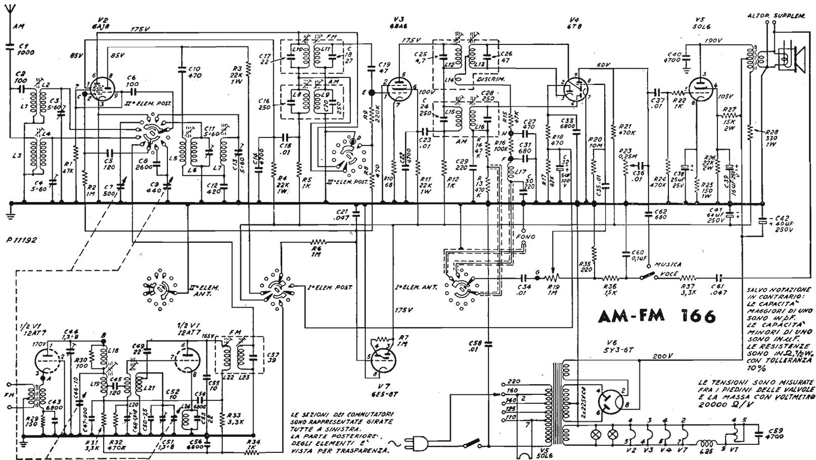
RADIO MARELLI - Mod. AM/FM 166. Apparecchio a modulazione d'ampiezza e di frequenza. Onde medie da 515 a 1640 kc/s. Onde corte da 3200 a 10 100 kc/s. Modulazione di frequenza da 87,5 a 100,5 Mc/s. MF/FM a 10,7 Mc/s, MF/AM a 455 kc/s.
