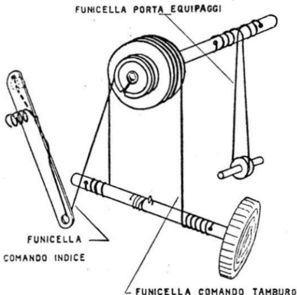
ISTRUZIONI PER IL CAMBIO DELLA FUNICELLA PORTA EQUIPAGGI (NUCLEI FERROMAGNETICI) DEGLI APPARECCHI MARELLI DELLE SERIE 9U65, 9A75, 9A85, 9A95 E SIMILI
