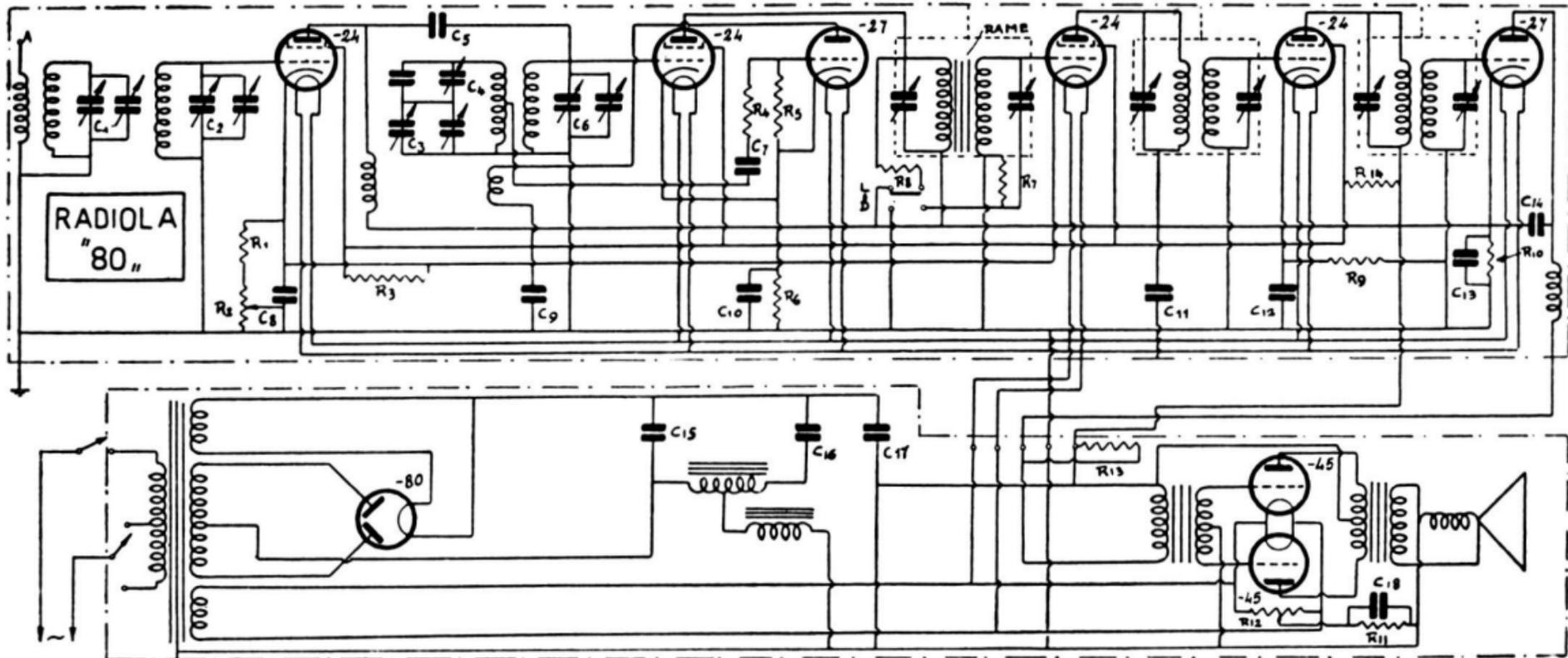
Onde medie. - M. F. 175 kc. - La prima apparsa delle moderne supereterodine. - Produzione 1929. - Oscillatrice separata 27. - Controfase di 45. - Potenza d'uscita: 4,5 watt.
