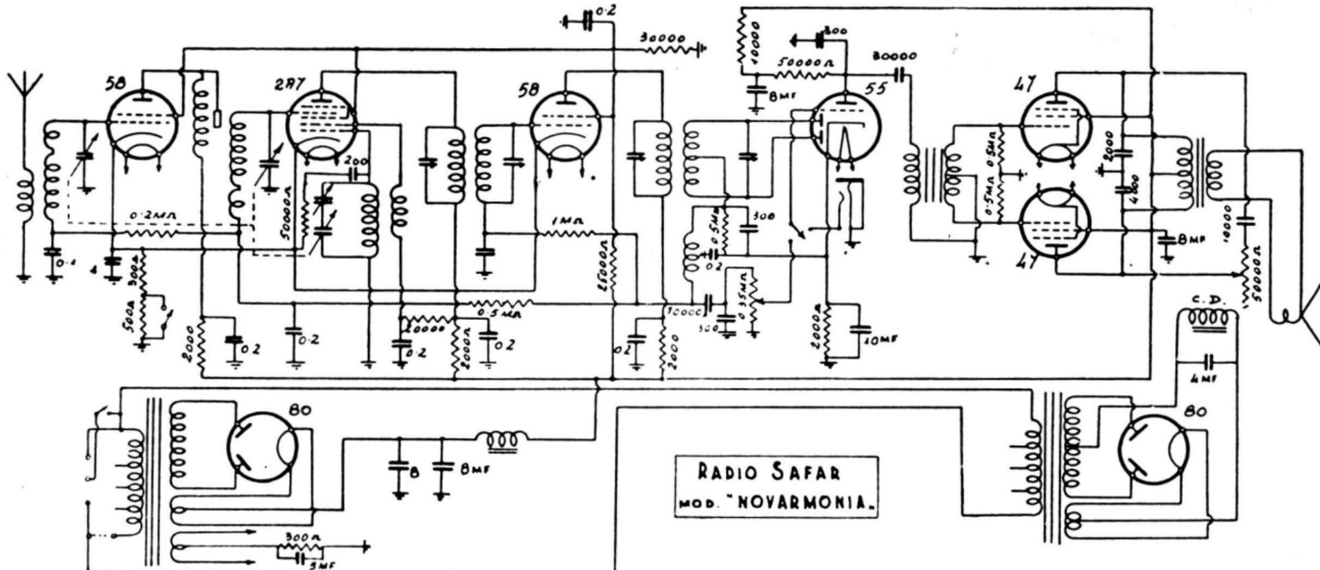
Onde medie. - M. F. 175 kc. - C. A. V. - C. T. - V. S. - 58 amplif. a. f.; 57 oscill.-modul.; 58 amplif. m. f.; 55 demodul.-c.a.v.; 47 in controfase e con polarizzazione automatica. - Dinamico con eccitazione separata. Potenza d'uscita: 7 watt.
