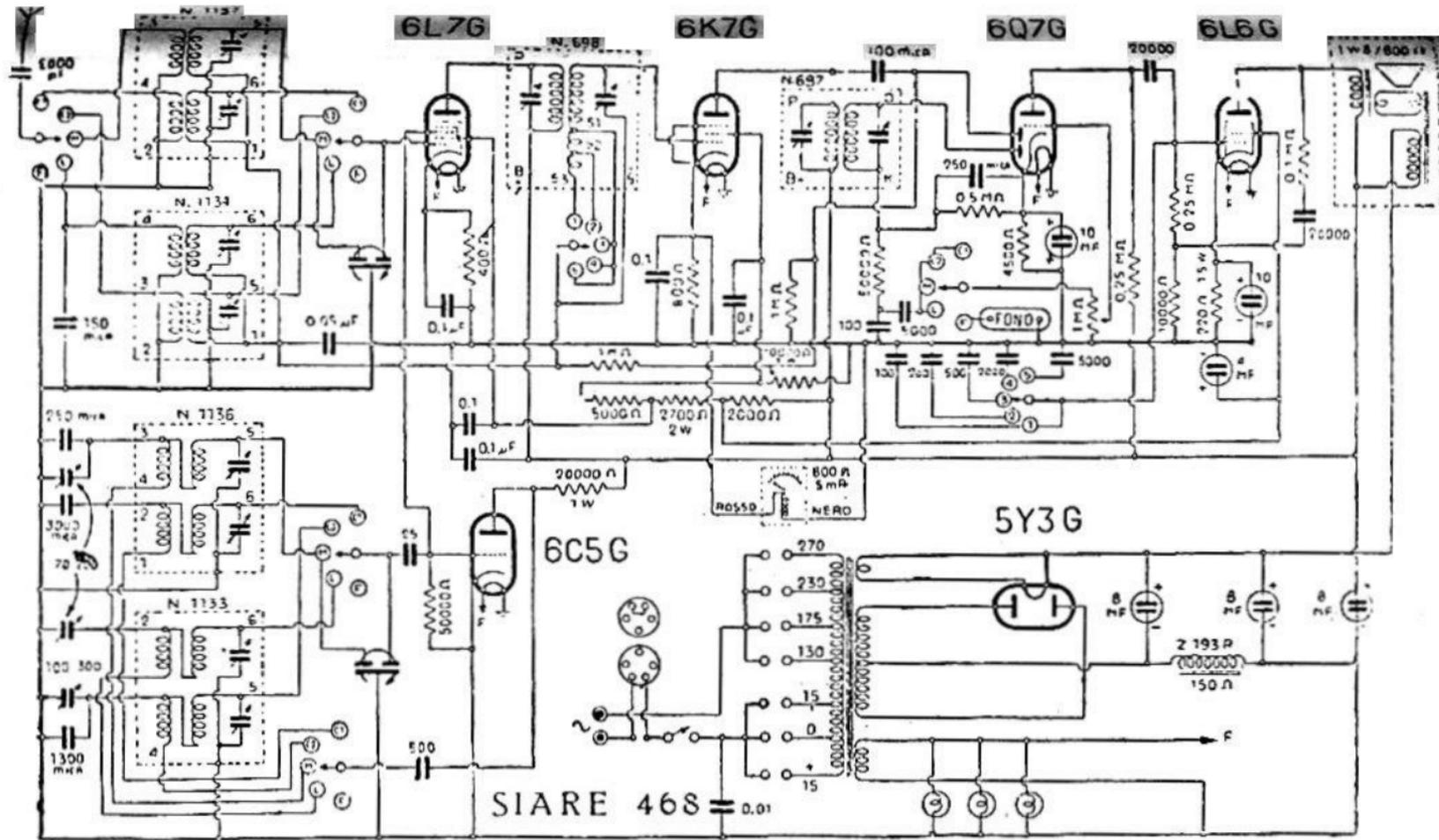
RADIO SIARE. — Mod. 468. — Produzione 1938-39. — Media frequenza: 467 kHz.
