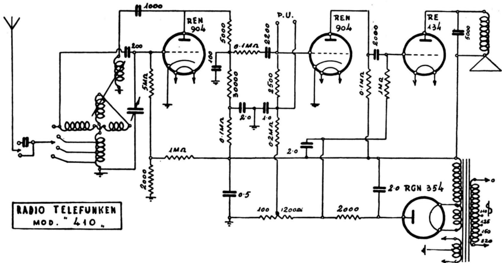
Rivelatrice in reazione seguita da un'amplif. di tens. e da una finale di potenza. - Diffusore magnetico. - Potenza: 1 watt.
