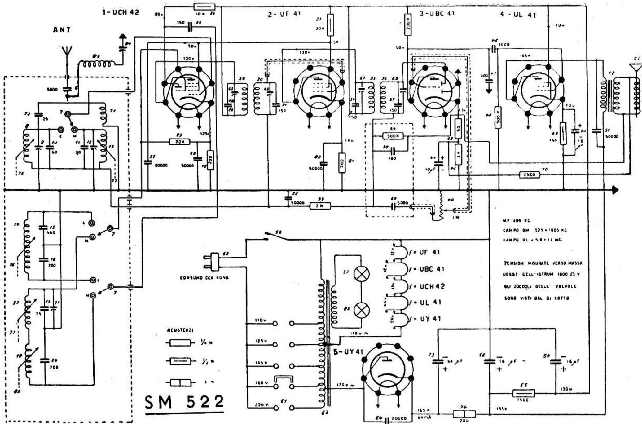
SIEMENS RADIO - Mod SM 522 - Onde medie e onde corte a permeabilità variabile. Media frequenza 469 kc. Placca rettificatrice 170 V, catodo 164 V continua a 64 mA. Tensione placca finale 155 V, schermo 130, catodo 7,2 V. Altre valvole 130 CV placca V. capitolo nono). Manopola e compensatori a parte.
