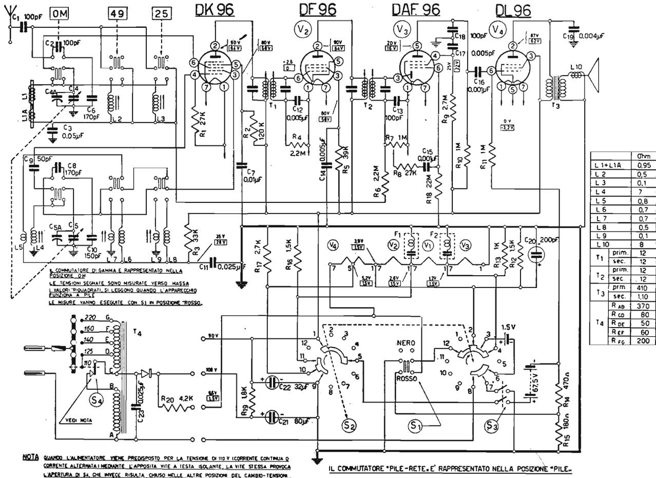
**VOXSON (Faret) - Mod. 603 Dinghy.** Portatile di tipo personale, a tre gamme d'onda, con alimentazione pile-rete. OM da 520 a 1600 kc/s, OC da 5,9 a 6,3 Mc/s (banda 49 metri) e OCS da 11,4 a 12,3 Mc/s (banda 25 metri). MF a 455 kc/s. Istruzioni come per i modd. 506 e 601.
