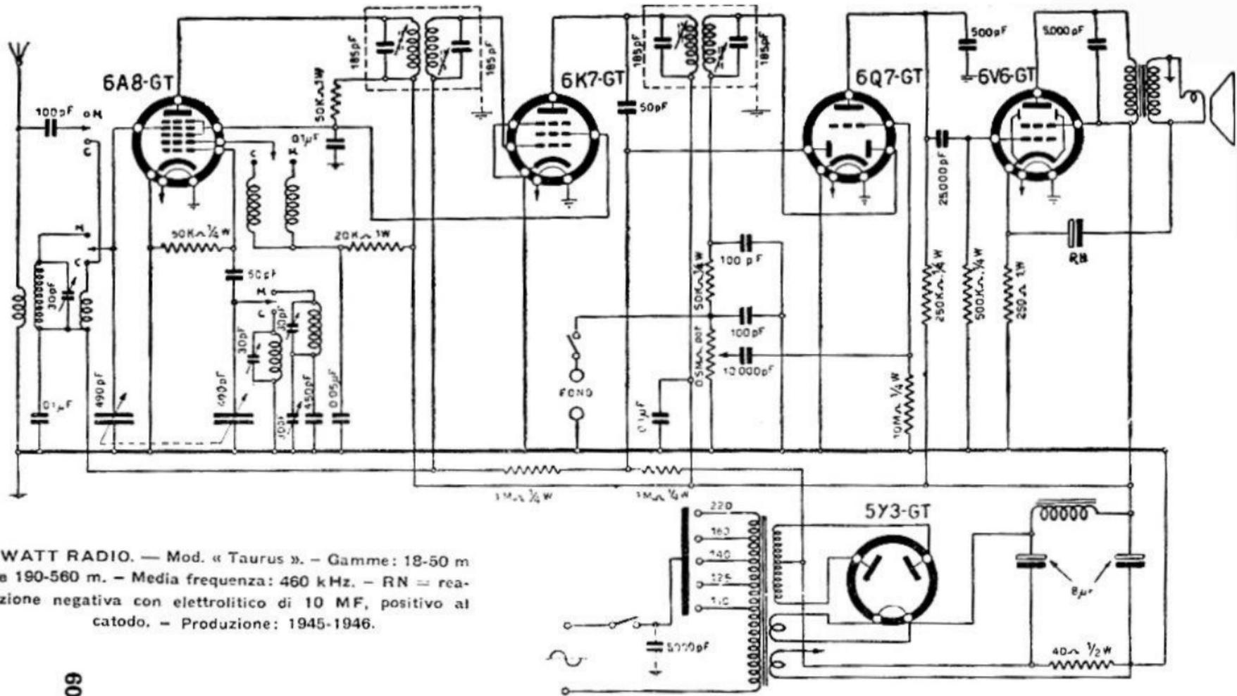
WATT RADIO. — Mod. « Taurus ». — Gamme: 18-50 m e 190-560 m. — Media frequenza: 460 kHz. — RN = reazione negativa con elettrolitico di 10 MF, positivo al catodo. — Produzione: 1945-1946.
