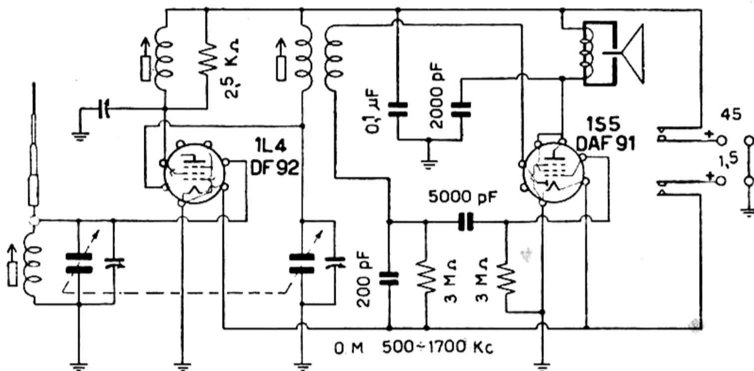
ZENITRON RADIO - Mod. DERBY RT 21 - Apparecchio ricevente portatile a mano, da usare come l'apparecchio telefonico, provvisto di antenna a telescopio, retrattile, lunga 40 cm. Funziona con due da 1,4 volt, e pile a secco presenti nell'interno dell'apparecchio. Potenza d'uscita 1,5 milliwatt. Dimensi 5,5, 6 cm. Peso 500 grammi.
