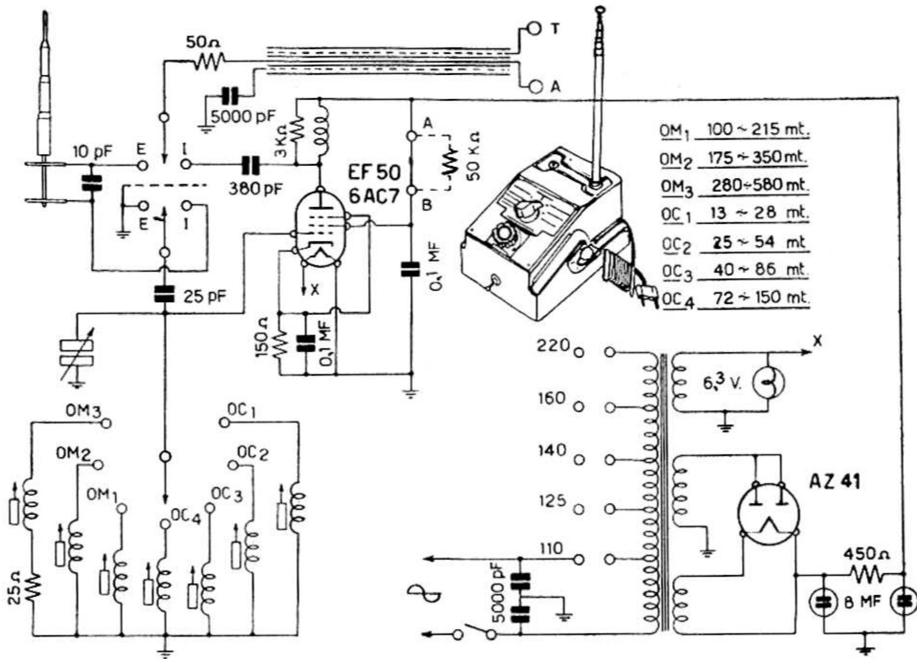
**ZENITRON RADIO** - Mod. Radio Pilota - Preamplificatore ad alta frequenza (booster) da collegare all'entrata di qualsiasi apparecchio radio per aumentarne la sensibilità. Gamma da 12,5 metri a 600 metri, suddivisa in tre campi d'onda media e quattro campi d'onda corta.
