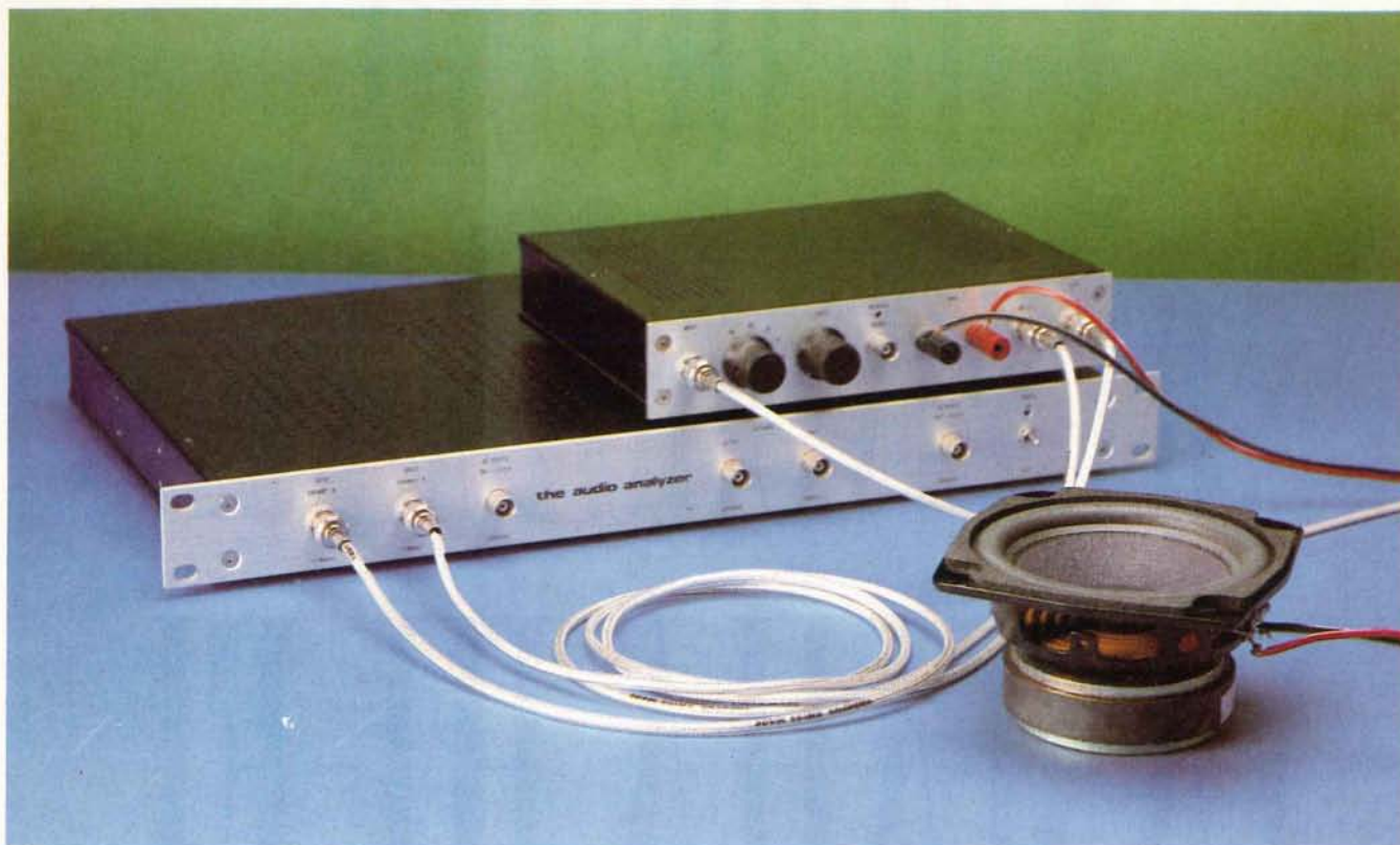
Figura 12 - L'uso dell'audio analyzer e dell'accessorio Impedance Box (collegati al computer in vostro possesso) facilita la procedura di misura dei parametri dell'altoparlante.
