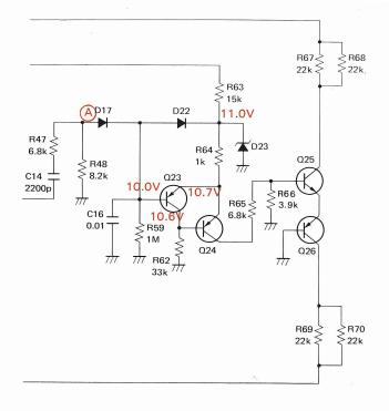
Fig. 17 HIGH-ON circuit
